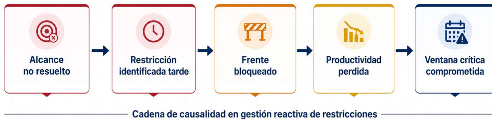
Figura 7.1 — Cadena de causalidad en gestión reactiva de restricciones / Fuente: AWP-T Framework
