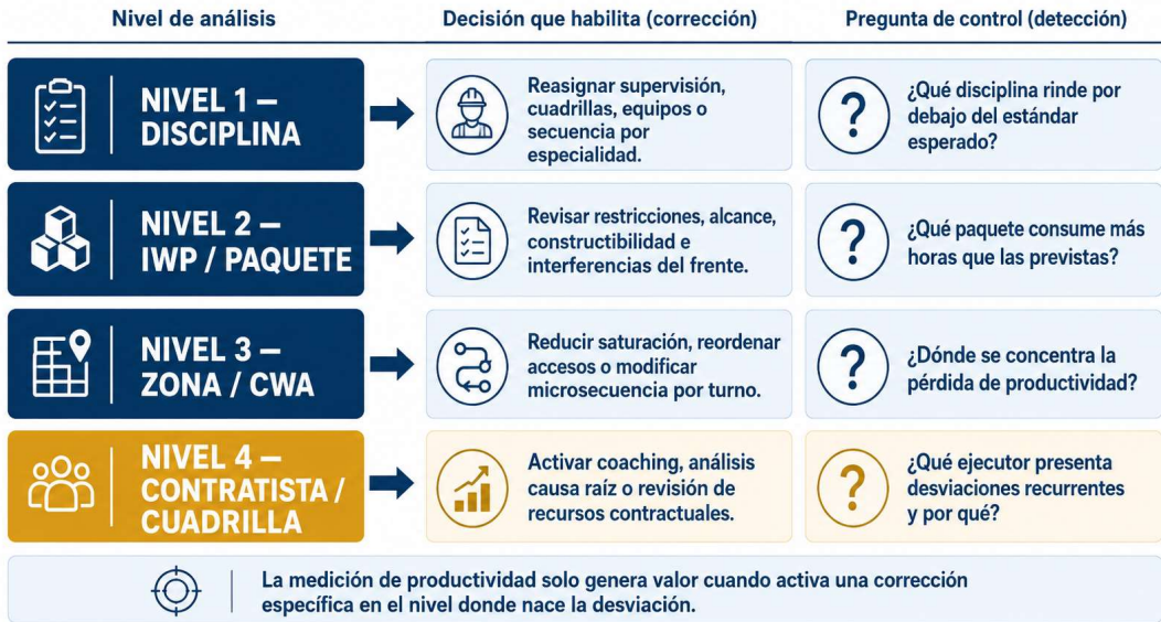
Figura 15.1 – Los cuatro niveles de medición de productividad AWP-T / Fuente: AWP-T Framework
