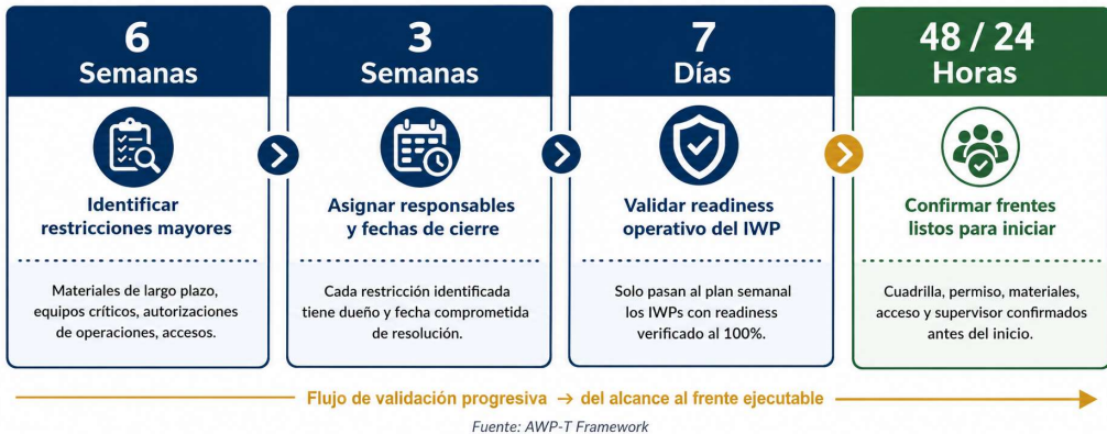
Figura 10.4 — Ventanas de lookahead AWP-T: validación progresiva de readiness / Fuente: AWP-T Framework
